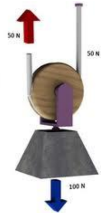
Roldanas - movimentos de sobe- desce conforme a roldana gira;
