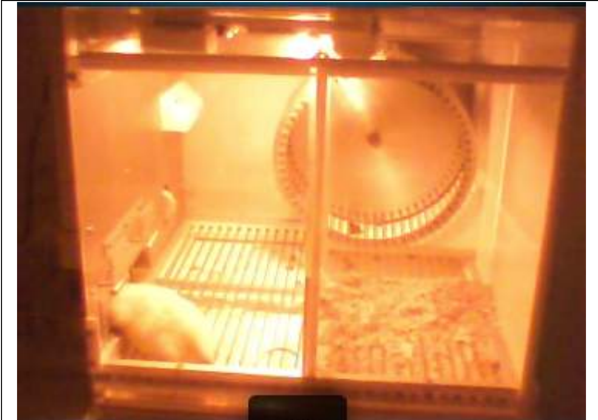
Figura 5. Foto do rato emitindo resposta de fuga da luz de 60 lux durante o período de claro do ciclo de claro-escuro obtida via monitoramento remoto no ambiente da Caixa de Atividade Diárias Para Ratos. Pode-se observar as barras que liberam água (esquerda) e alimento (direita) na parede ao lado esquerdo da foto, o disco de madeira (a direita das barras), a roda de atividades e o ambiente de maravalha (ninho). A luz central e os sensores de movimento estão localizados no teto da caixa.
